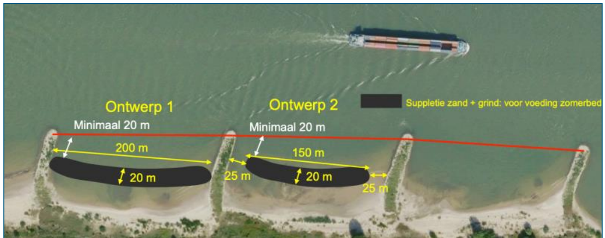
Figuur 2 Schets van de voorgestelde uitvoering van de suppletie van kribvakken volgens 2 ontwerpen (1) een ontwerp waarbij de suppletie aansluit op beide kribben (linker kribvak), en (2) een ontwerp waarbij tussen de suppletie en beide kribben een afstand van 25 m wordt aangehouden (rechter kribvak). De rode lijn verbindt de bakens op de koppen van de kribben.
