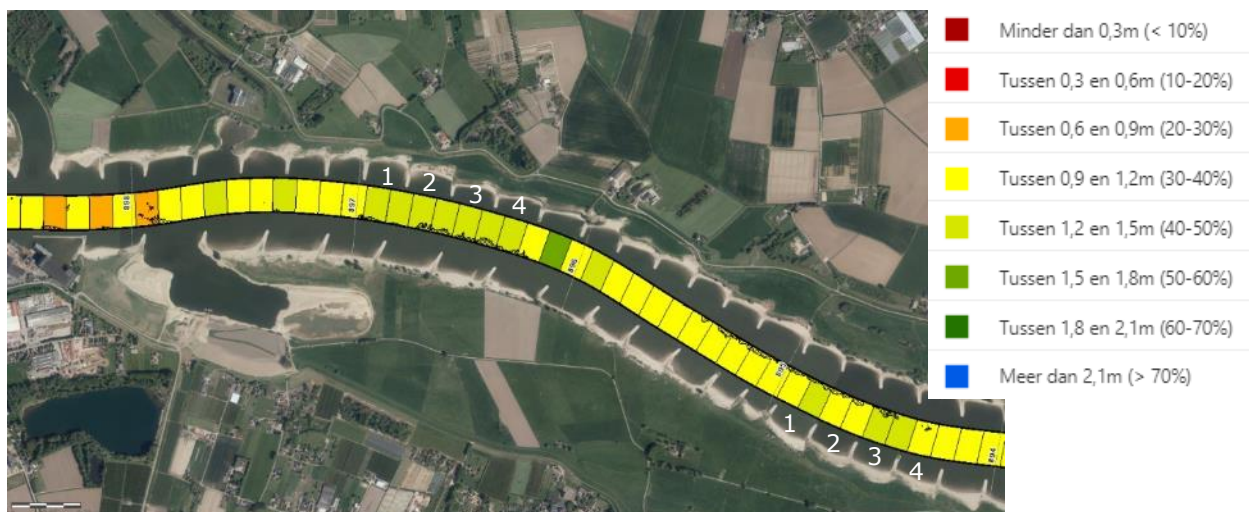
Figuur 15: Breedtegemiddelde diepte in de vaargeul bij suppletieclusters 2 en 3 t.o.v. de norm (waterdiepte bij OLR - 2,80m). Voor scheepvaart dient 1,2m beschikbaar te zijn voor voldoende kielspeling. In geruite gebied is waterdiepte onvoldoende.
