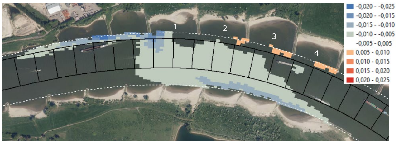
Figuur 13: Jaargemiddelde aanzanding en erosie (m) in de vaargeul bij suppletiecluster 1. Kleine bodemveranderingen (< 0,5cm) zijn niet getoond.
