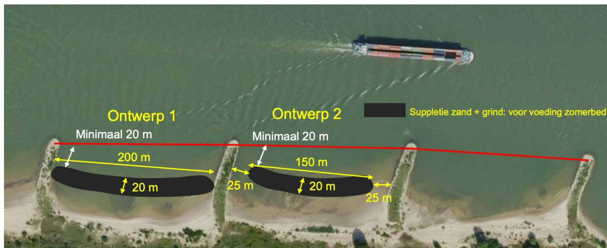
Figuur 8. Schets van de voorgestelde uitvoering van de suppletie van kribvakken, volgens 2 ontwerpen (1) een ontwerp waarbij de suppletie aansluit op beide kribben (boven), en (2) een ontwerp waarbij tussen de suppletie en beide kribben een afstand van 25 m wordt aangehouden (onder). De rode lijn verbindt de bakens op de koppen van de kribben.
