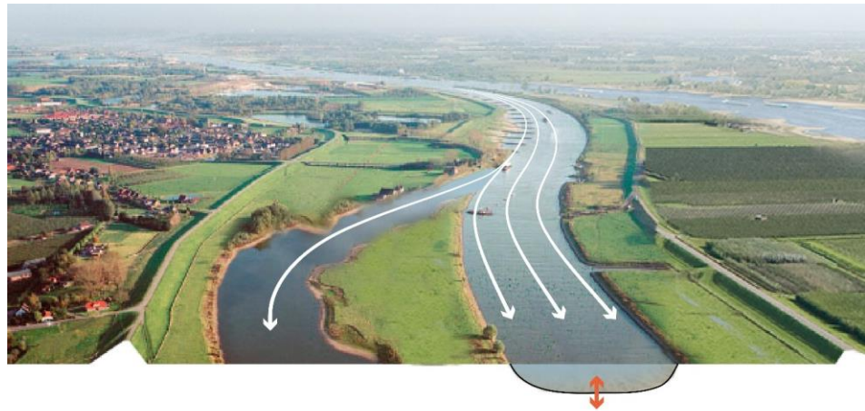
Figuur 6: Meestromende nevengeulen. Erosie (oranje pijl) wordt afgeremd.
