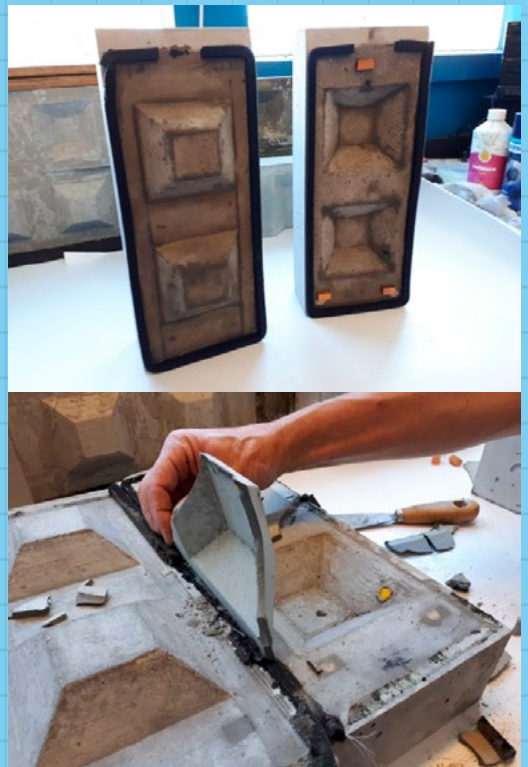
Schaalproef, voor en na. Voeg laat direct los
