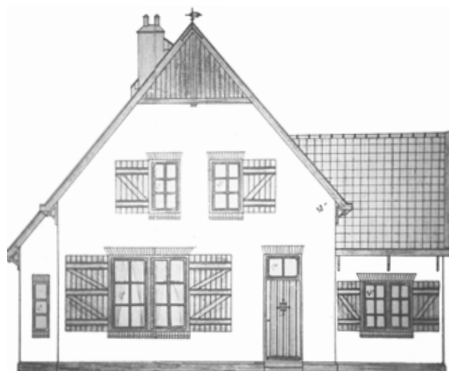
Voorgevel aanzicht van de brugwachterswoning zoals toegepast bij de ophaalbruggen en de draaibruggen.
