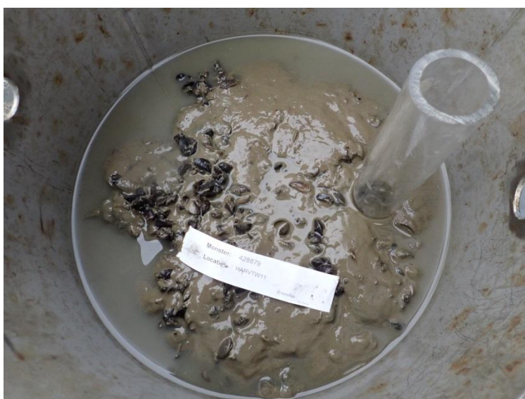
Figuur 2-4: Diep gestoken monster op locatie HARVTW11 met intact monsteroppervlak
