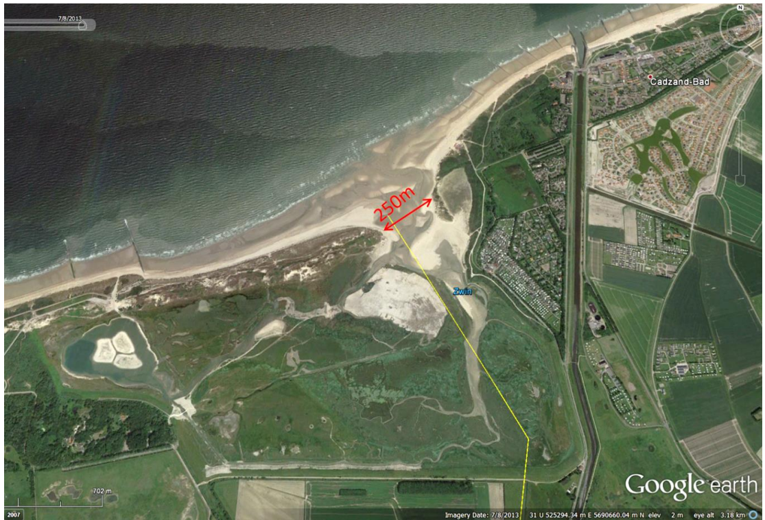
Figuur 3.21 Het Zwin voorafgaand aan de uitbreiding die in 2019 voltooid is. De gele lijn geeft de Nederlands-Belgische grens aan. Onderaan is in het midden van de foto de Internationale dijk zichtbaar die doorgebroken is ten behoeve van de uitbreiding.
