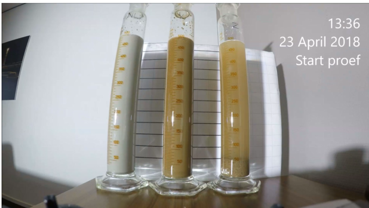
Figuur 2: De transparantie 8 minuten na het homogeniseren van de kolommen met zand als laatste: De strepen achter de kolommen zijn niet door de kolommen te zien.
