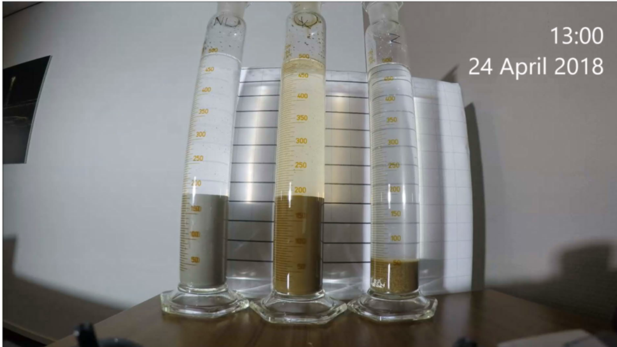
Figuur 3: De toestand ongeveer 24 uur na het begin van het bezinken. De kolom met zand is nagenoeg geheel helder en in de kolom met Noordse Leem, links, is zijn de strepen achter de kolom duidelijk te zien. De strepen zijn niet te zien in de kolom met de klei.
