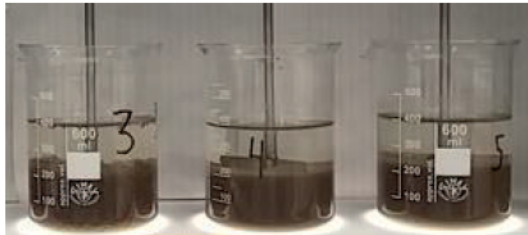
AFBEELDING 25 JARTEST (JT8) MET SLIB VAN RWZI LEEUWARDEN. BEKERGLAS 1: NORMAAL PE, BEKERGLAZEN 2-6: VERSCHILLENDE KATIONISCHE TANNINES. ALLE BEKERGLAZEN HEBBEN EEN GELIJKE DOSERING (100% = 1,6 G/KG DS).
