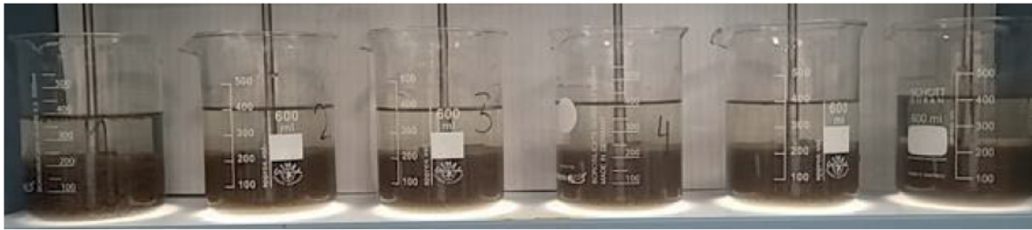
AFBEELDING 22 JARTEST (JT12) MET SLIB VAN RWZI LEEUWARDEN. BEKERGLAS 1: NORMAAL PE, BEKERGLAZEN 2-6: VERSCHILLENDE KATIONISCHE ZETMELEN. ALLE BEKERGLAZEN HEBBEN EEN GELIJKE DOSERING (100% = 1,6 G/KG DS).
