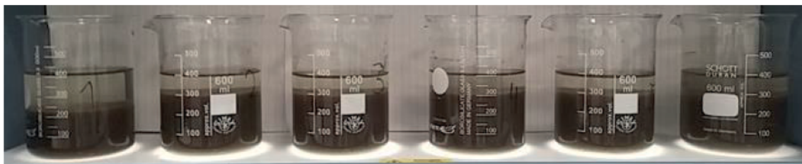
AFBEELDING 26 JARTEST (JT8) MET SLIB VAN RWZI AMSTERDAM. BEKERGLAS 1: NORMAAL PE, BEKERGLAZEN 2-6: VERSCHILLENDE KATIONISCHE TANNINES. ALLE BEKERGLAZEN HEBBEN EEN GELIJKE DOSERING (100% = 7,0 G/KG DS).
