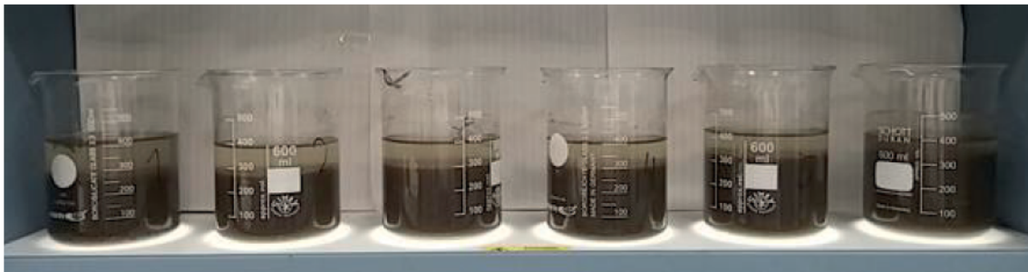
AFBEELDING 23 JARTEST (JT11) MET SLIB VAN RWZI AMSTERDAM. BEKERGLAS 1: NORMAAL PE, BEKERGLAZEN 2-6: VERSCHILLENDE KATIONISCHE ZETMELEN. ALLE BEKERGLAZEN HEBBEN EEN GELIJKE DOSERING (100% = 7 G/KG DS).
