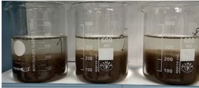
AFBEELDING 28 JARTEST (JT15) MET SLIB VAN RWZI LEEUWARDEN. BEKERGLAS 1: NORMAAL PE, BEKERGLAS 2: CH1, BEKERGLAS 3: CH2. ALLE BEKERGLAZEN HEBBEN EEN GELIJKE DOSERING (100% = 1,6 G/KG DS).
