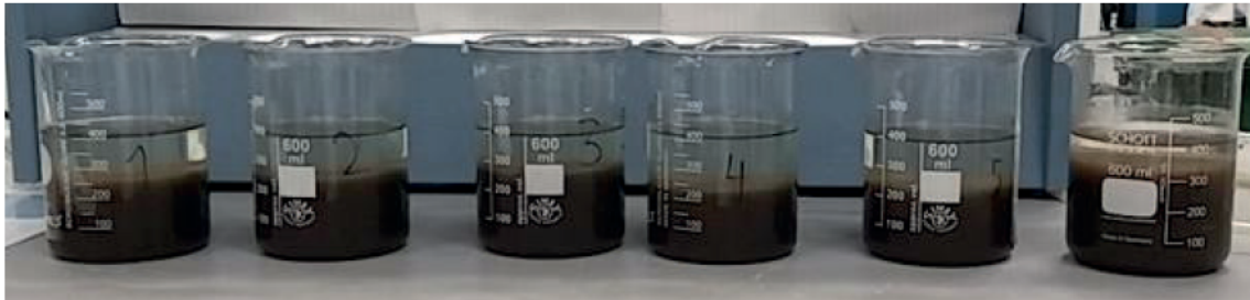
AFBEELDING 23 JARTEST (JT11) MET SLIB VAN RWZI AMSTERDAM. BEKERGLAS 1: NORMAAL PE, BEKERGLAZEN 2-6: VERSCHILLENDE KATIONISCHE ZETMELEN. ALLE BEKERGLAZEN HEBBEN EEN GELIJKE DOSERING (100% = 7 G/KG DS).
