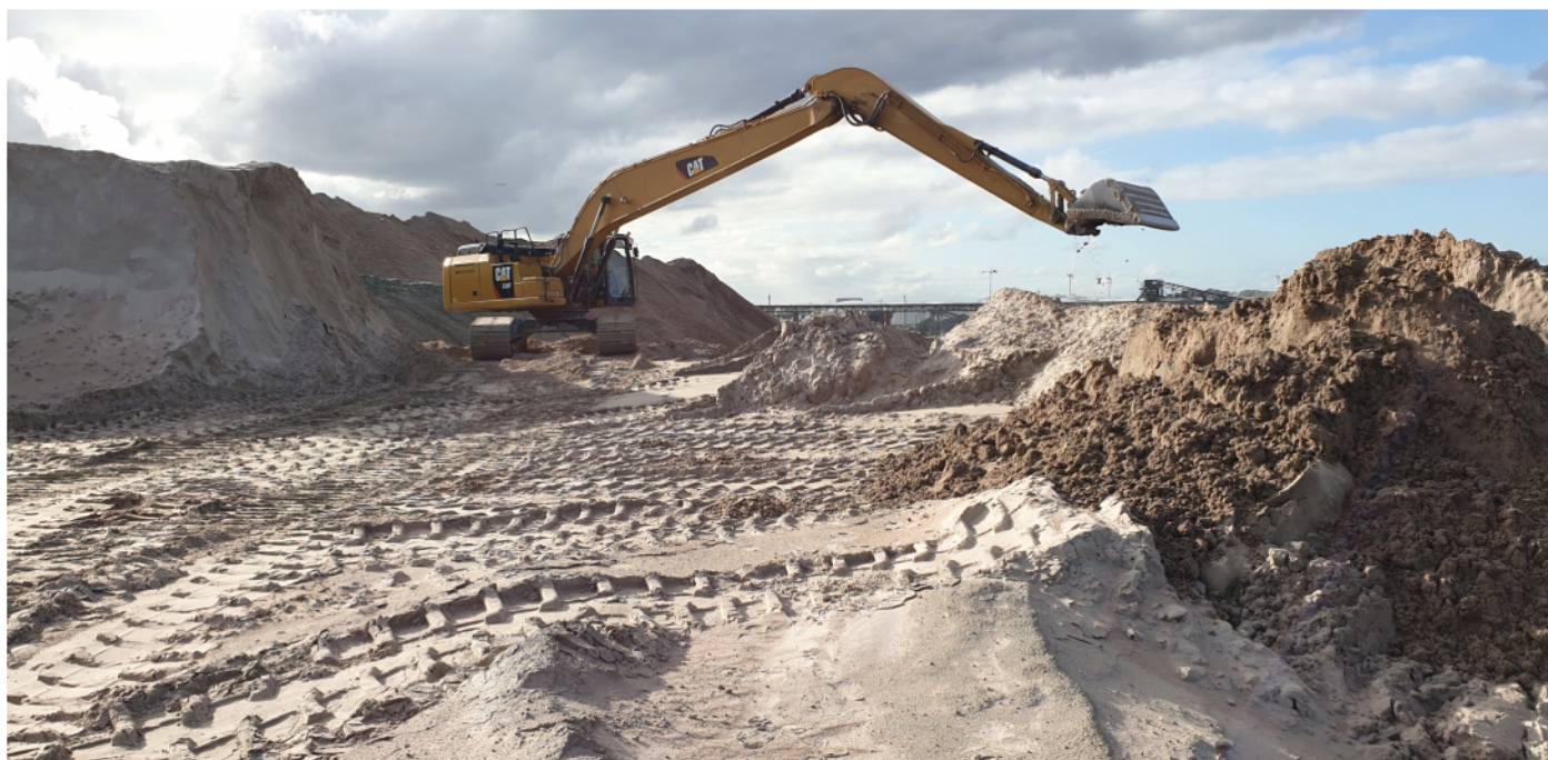
Foto 4: bemonstering met behulp van graafmachine
