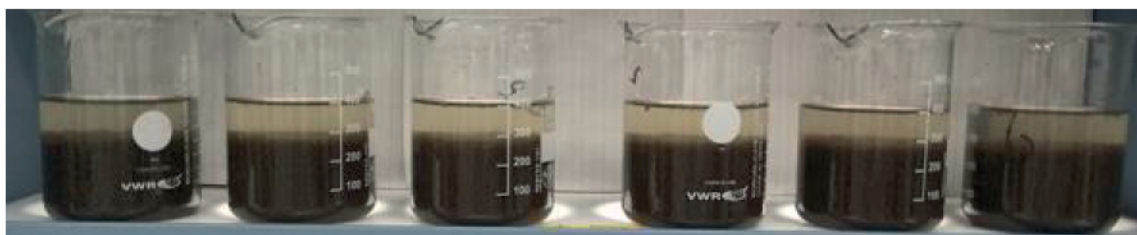
AFBEELDING 32 JARTEST (JT30) MET SLIB VAN RWZI AMSTERDAM. BEKERGLAS 1 & 6: 100% PE, BEKERGLAZEN 2-5: 75% PE. BIJ GLAS 3,4 EN 5 OPLOPENDE DOSERING CYCLODEXTRINE: 0,25; 0,5 EN 1,0 G/KG DS.
