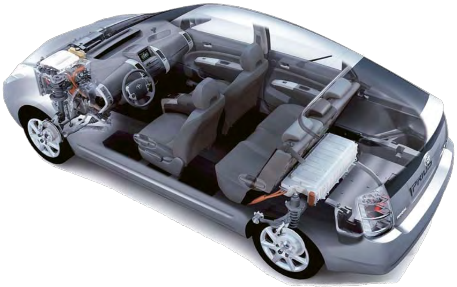
Een uitsnede van de Toyota Prius. Linksvoor is de elektromotor zichtbaar en rechtsachter de batterij.
