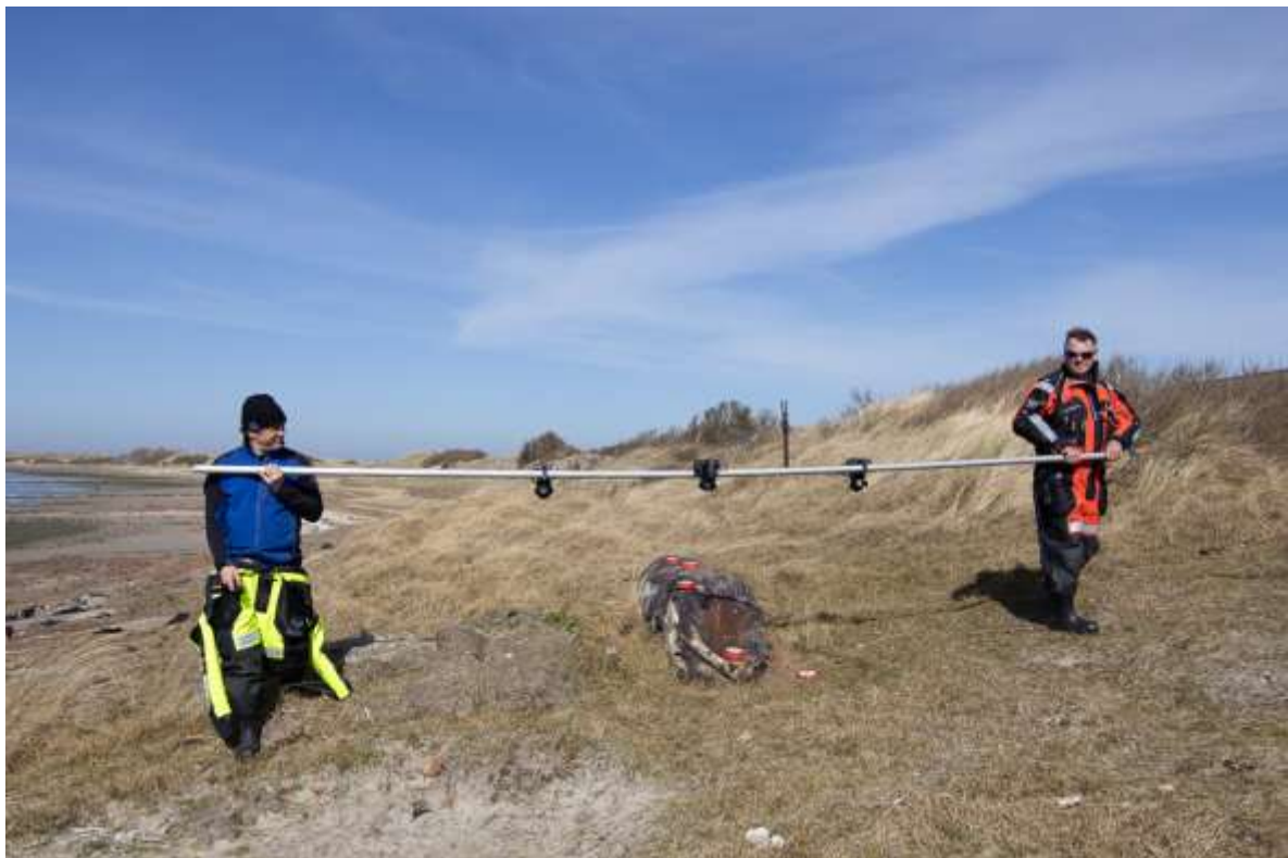
Figuur 8. Drie fototoestellen aan een lange stang voor het maken van overlappende foto's. Foto: Nicole Janinhoff-Verdaat, 30-03-2021.
