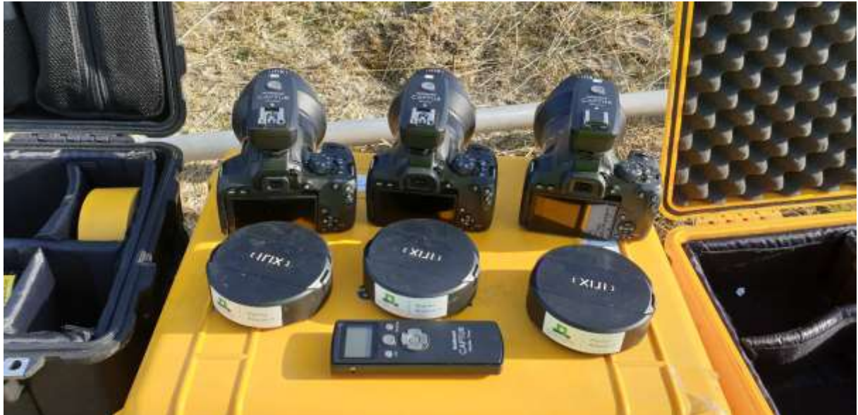
Figuur 7. Drie fototoestellen met groothoeklens en afstandsbediening voor het maken van de orthofoto's van het kadaver. Foto: Hans Verdaat, Wageningen Marine Research, 25-02-2021.
