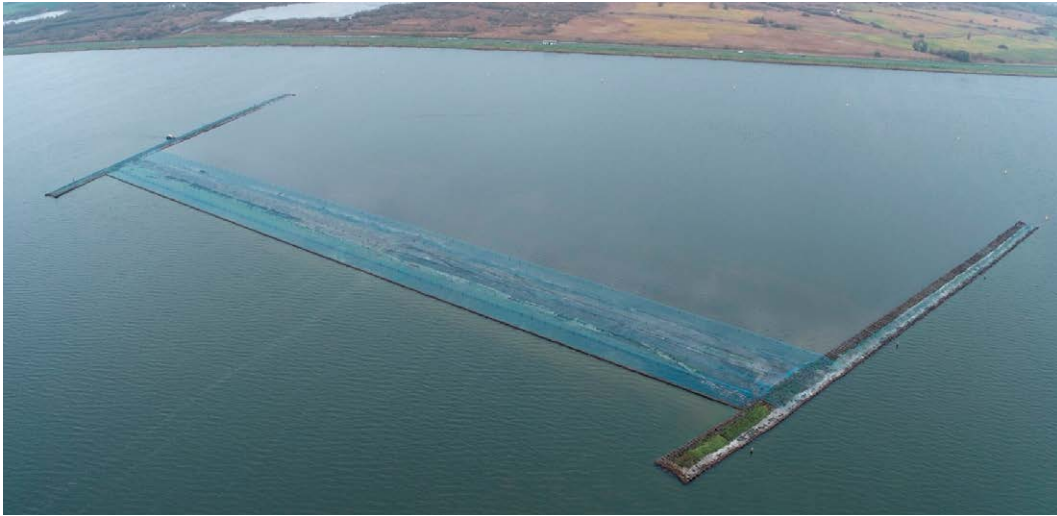
Aanleg van legakkers in het Wolderwijd | Martens en Van Oord
