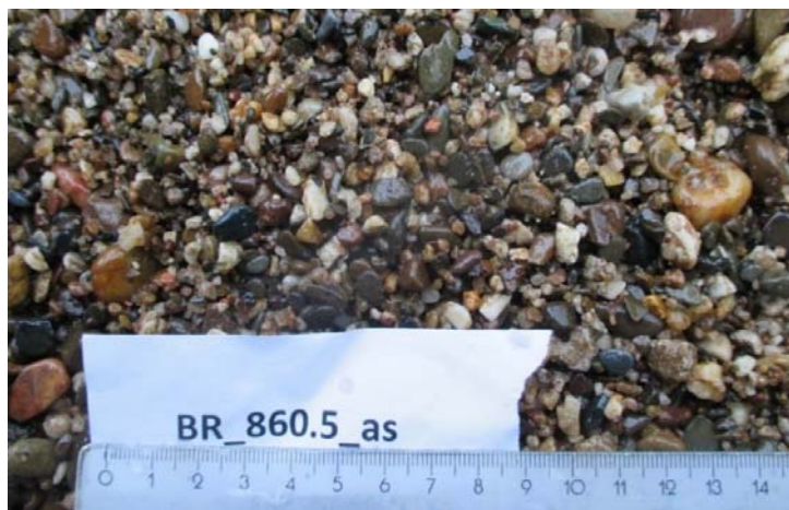
Figuur 5: Sediment aan het oppervlak van het zomerbed op de as van de rivier bij rkm 860.5; bemonsterd in het najaar 2019.
