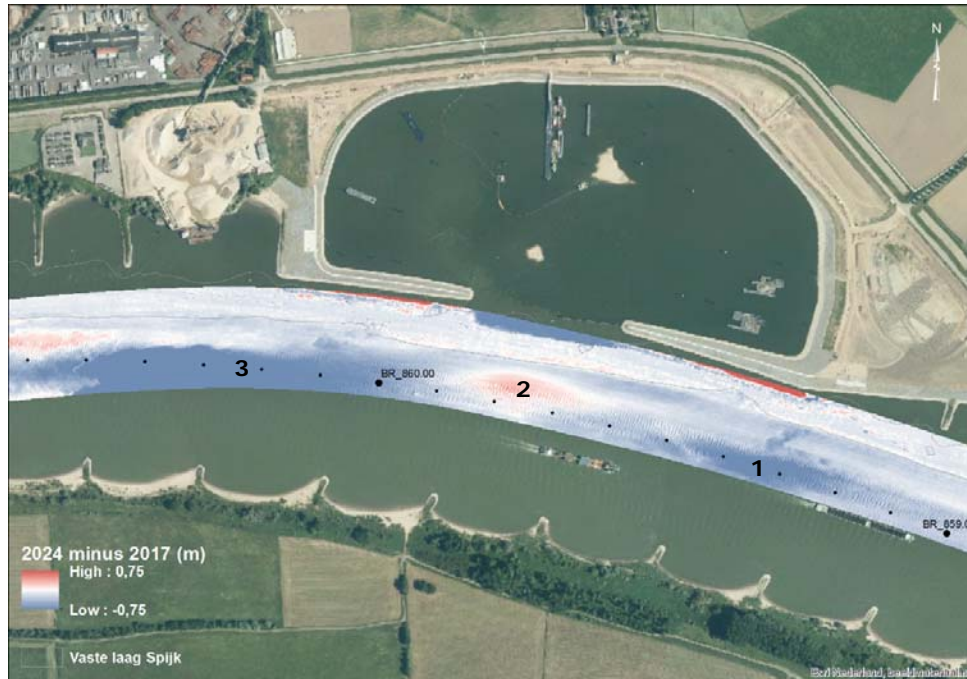
Figuur 13: Bodemverschilkaart (m) tussen de voorjaarspeiling 2017 en de meest recente vaargeulpeiling van 5 februari 2024". Let op : de schaal is gelimiteerd zodat erosie en sedimentatie patronen goed te onderscheiden zijn. Voor de absolute ligging wordt verwezen naar het lengteprofiel (figuur 10). De nummers geven erosie en sedimentatie patronen weer die zijn te relateren aan de geometrie van de haven.
