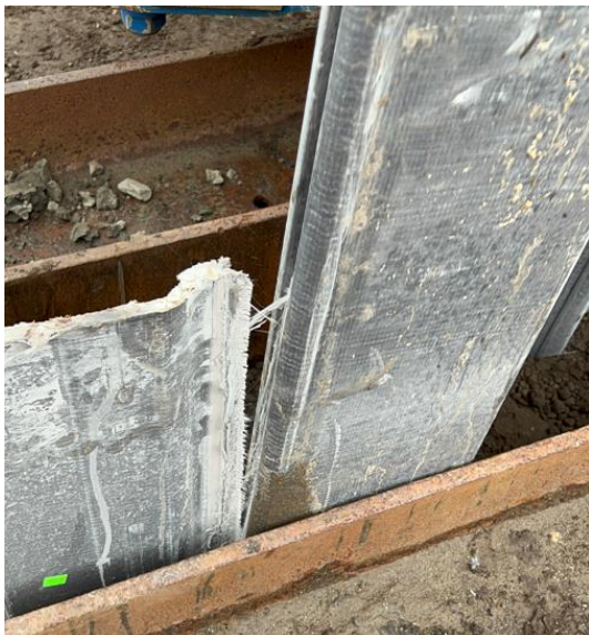
Figuur 11 - Gescheurd slot kunststof damwand
