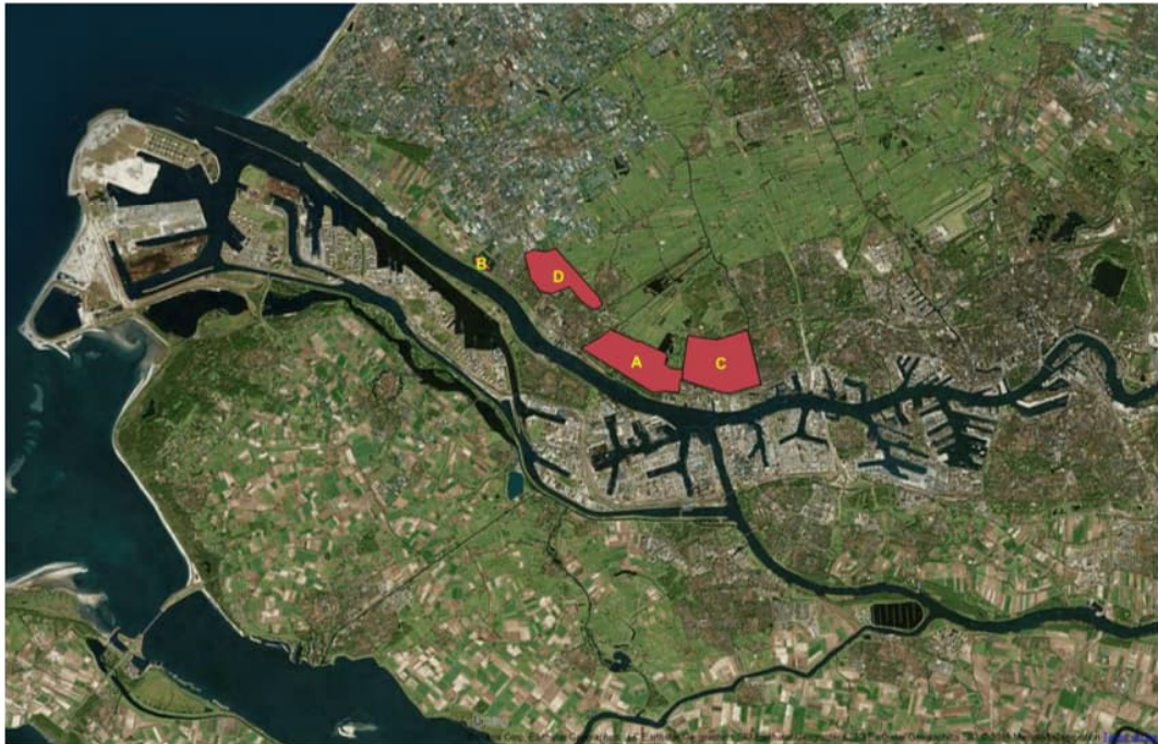
Figuur 7.2 Gebieden waar EC-routing in het oppervlaktewaterstelsel en prikstokmetingen in de slootbodembodem uitgevoerd worden.
