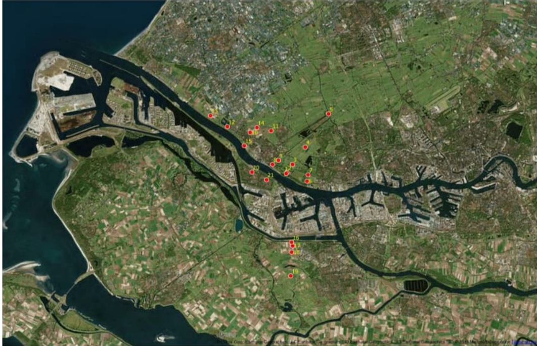
Figuur 7.1 Meetpunten waar EC-sondering en (niet overal) peilbuismetingen uitgevoerd worden.
