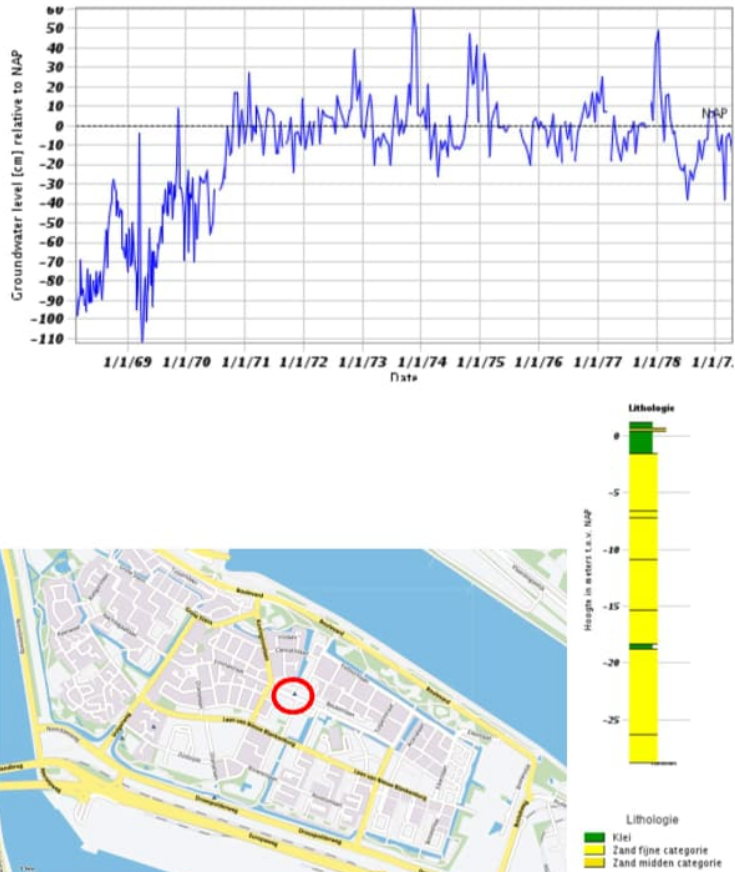
Figuur 5.5: Stijghoogte op ca. NAP -7 m (boven), NAP -25 m (midden) en locatie en bodemopbouw van het betreffende DINO-grondwatermeetpunt B37D0337. Bron: DINOloket.
