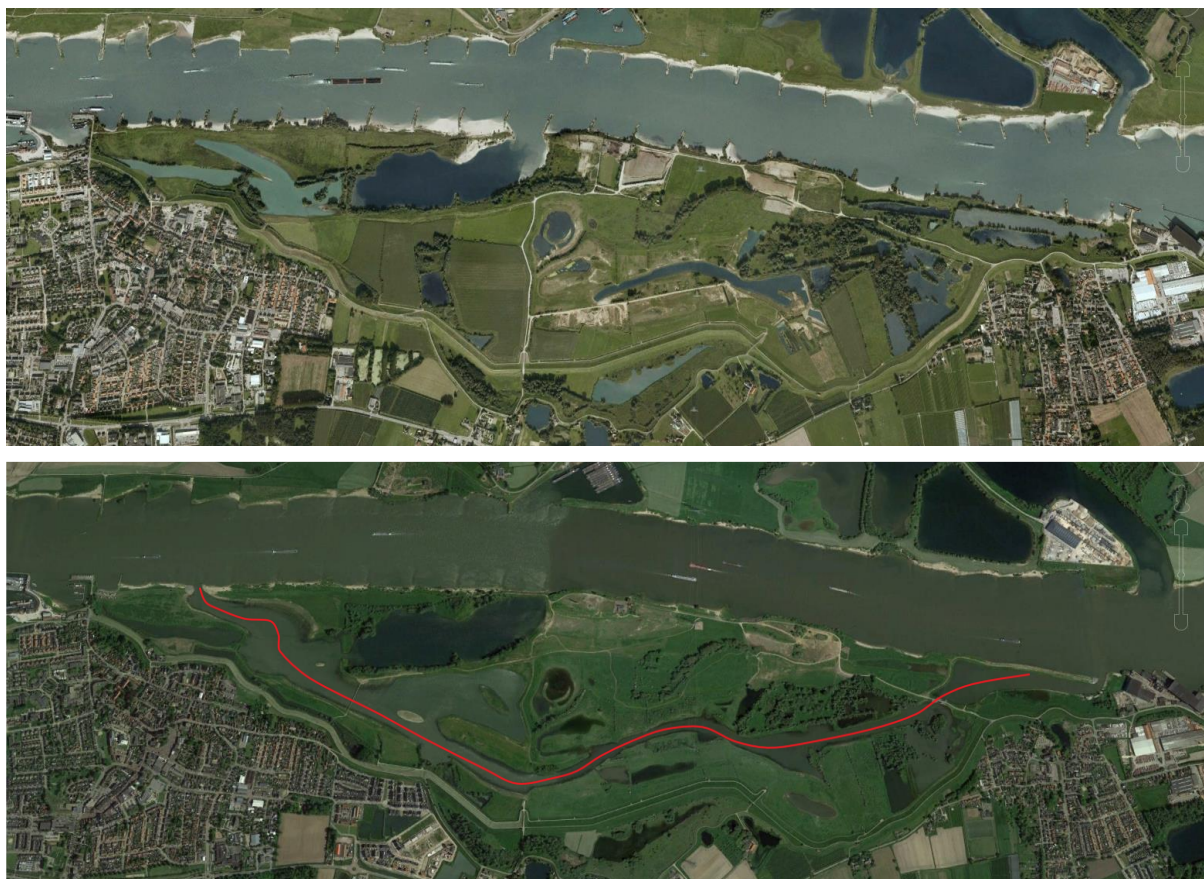
Figuur 17: Boven: Afferdensche en Deestsche Waarden voor het verlagen van de uiterwaard en de aanleg van de gehele nevengeul, december 2005; Beneden: Afferdensche en Deestsche Waarden na de ingrepen (rode lijn: nevengeul), mei 2021 (Google Earth).
