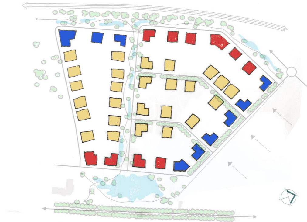
Kaart 13: drie verschillende gebouwhoogten op basis van locatie binnen het gebied: rood: 12 tot 15m hoog; geel: 8 tot 12m hoog; blauw: tot 8m hoog.
