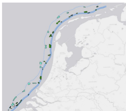
Figuur E1. Overzicht van zoekgebieden voor winning suppletiezand op de Noordzee. De lichtblauwe vakken zijn het zeewaartse alternatief, de groene vakken het landwaartse alternatief. De blauwe lijnen geven de grens van het kustfundament en de 12-mijlsgrens aan (van Duin et al., 2017).
