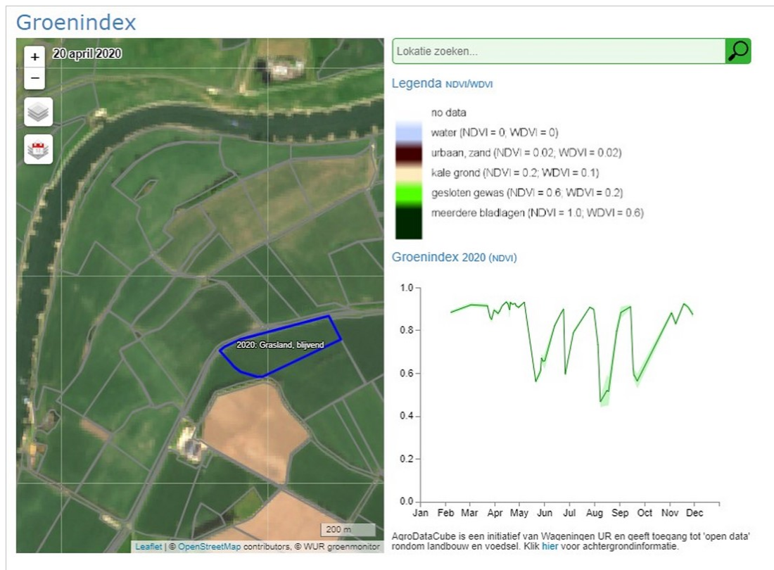
Figuur 10: Maat voor gezondheid van gewassen: NDVI. Duidelijk is te zien dat dit perceel vier maaibeurten heeft gekend. Bij maaien krijg je namelijk een dip in de NDVI-waarden.
