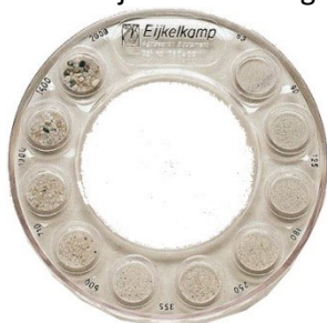
Figuur 2.1: Een Zandliniaal, in het midden van de schijf wordt het monster gelegd en met een loep wordt bepaald wat de korrelgrootte is en vergelijken met de monsters in de Zandliniaal.
