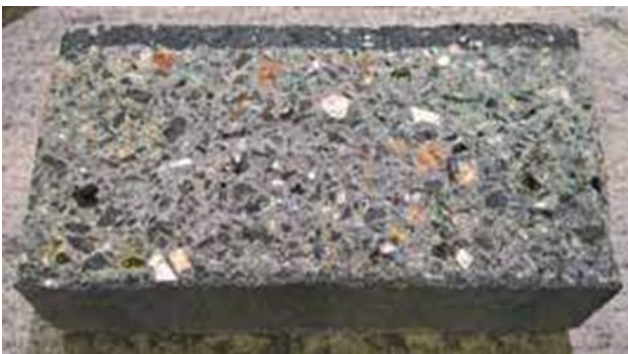
Figuur 2 AEC granulaat in beton
