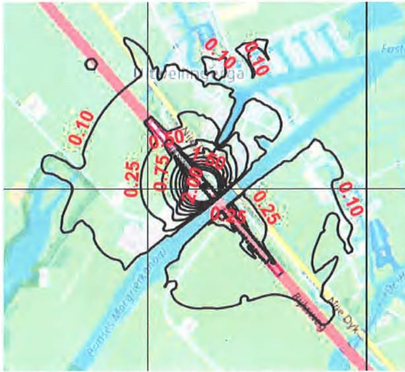
Figuur B.1: Daling grondwaterstand als gevolg van bemaling moot 26 tot NAP -10,3 m.
