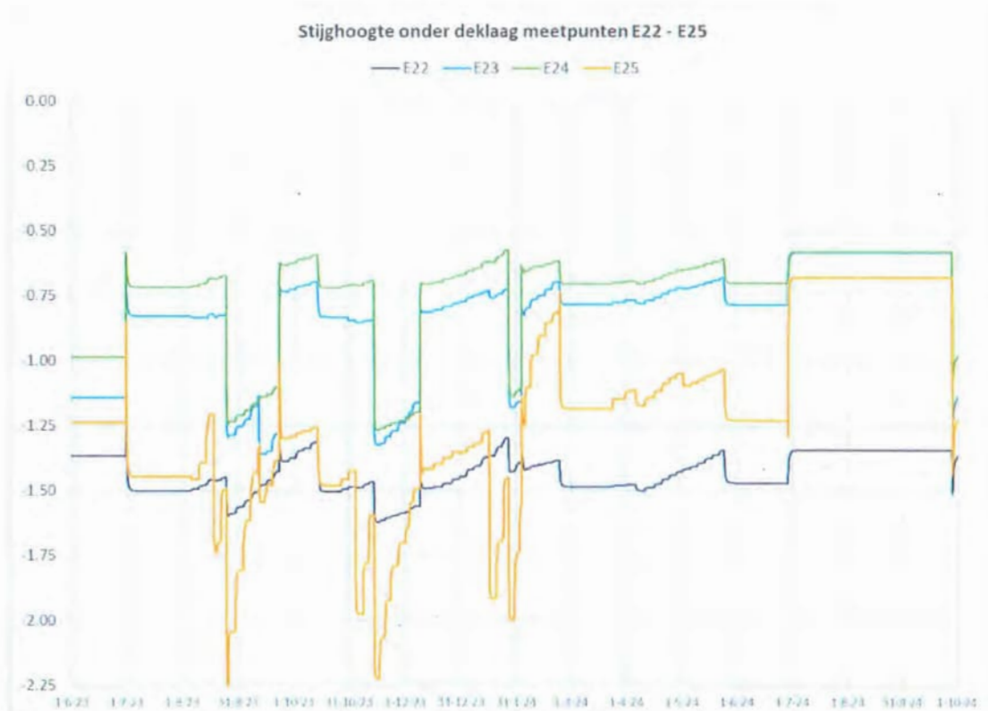
Figuur 6-16: Bemalingsscenario 3; stijghoogte onder de deklaag tijdens bemalen E22 t/m E25.
