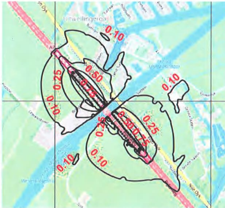
Figuur B.5: Daling waterspanning in tussenzandlaag (boven Keileem) als gevolg van bemaling tunnelbak tot NAP -3 m.
