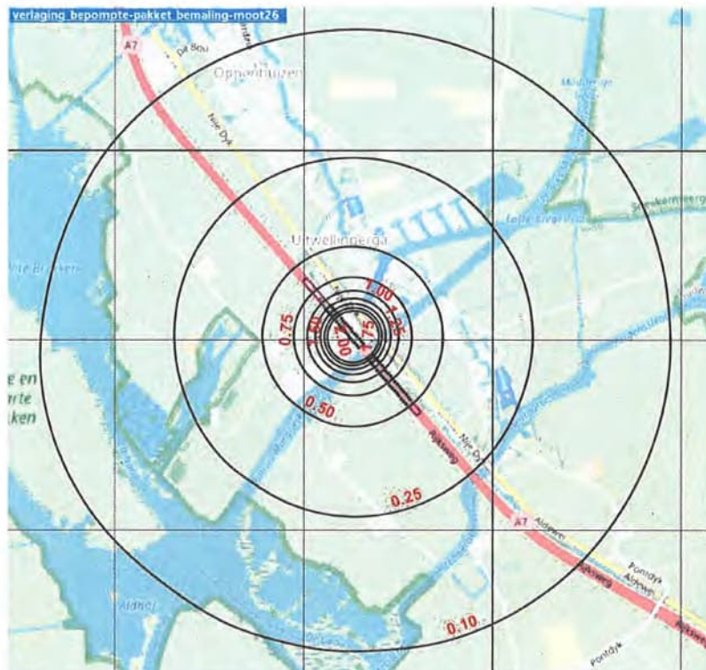
Figuur B.3: Daling waterspanning in pleistocene zand tot circa NAP -30 m als gevolg van bemaling moot 26 tot NAP -10,3 m.
