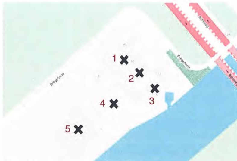
Figuur 6-8: Meetpunten waar grondwater en stijghoogte tijdens bemaling is bepaald voor scenario 5.
