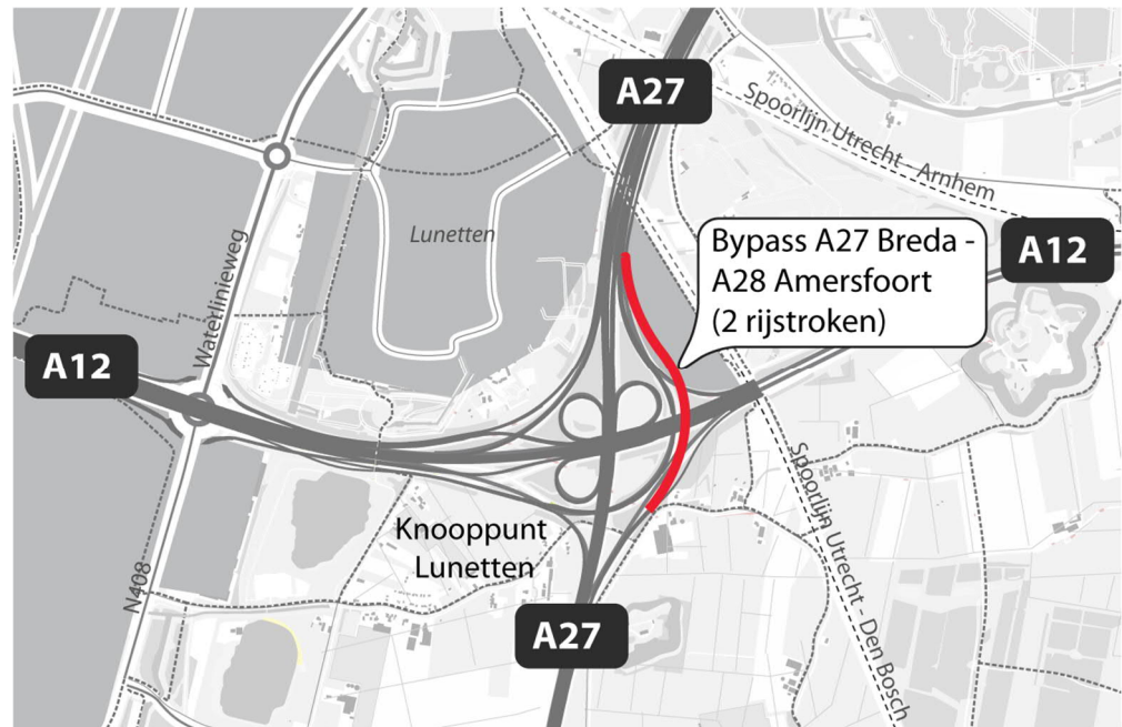
Figuur 3.5: Bypass knooppunt Lunetten (schematisch)
