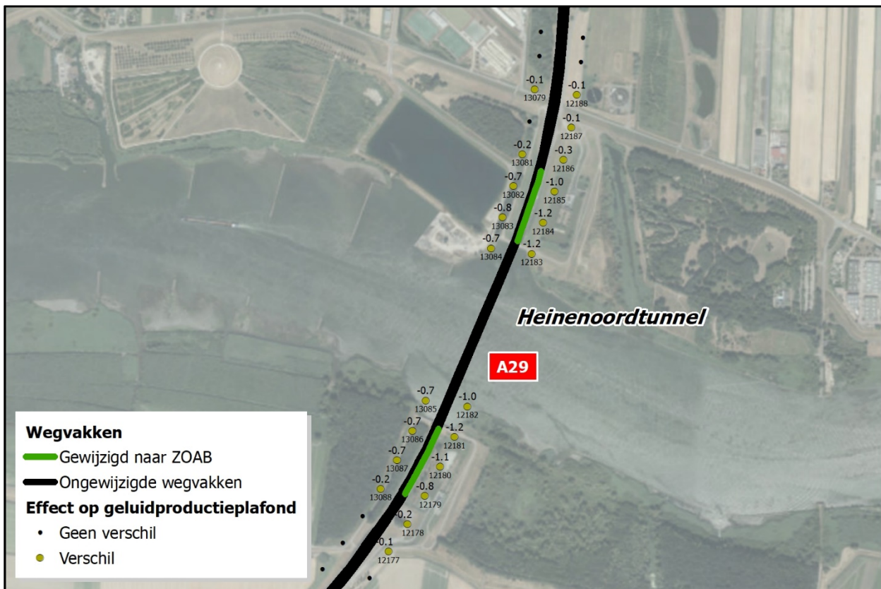
Figuur 1: Ligging wegvakken A29 met aangepaste wegdekverharding ter hoogte van de Heinenoordtunnel
