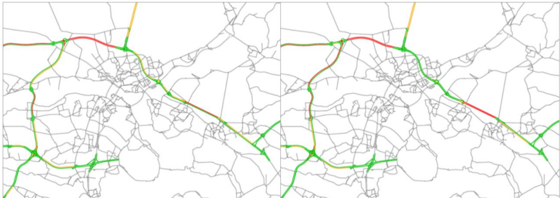
Afbeelding 4-2 I/C-verhouding ochtendspits (links) en avondspits (rechts) in de autonome situatie, waarbij een rode arcering staat voor een I/C waarde van meer dan 0,9 (=weinig tot geen restcapaciteit), een oranje arcering staat voor een I/C waarde van tussen de 0.8 – 0.9 (=beperkte restcapaciteit), een groene arcering staat voor een I/C waarde van minder dan 0.8 (= voldoende restcapaciteit)
