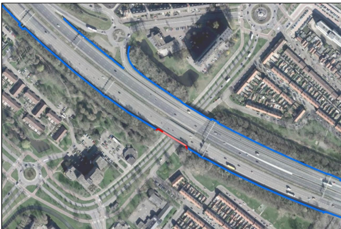
Figuur 23: A16 t.h.v. viaduct Koninginneweg Zwijndrecht – afschermende objecten met onjuiste M-waarden (rood)
