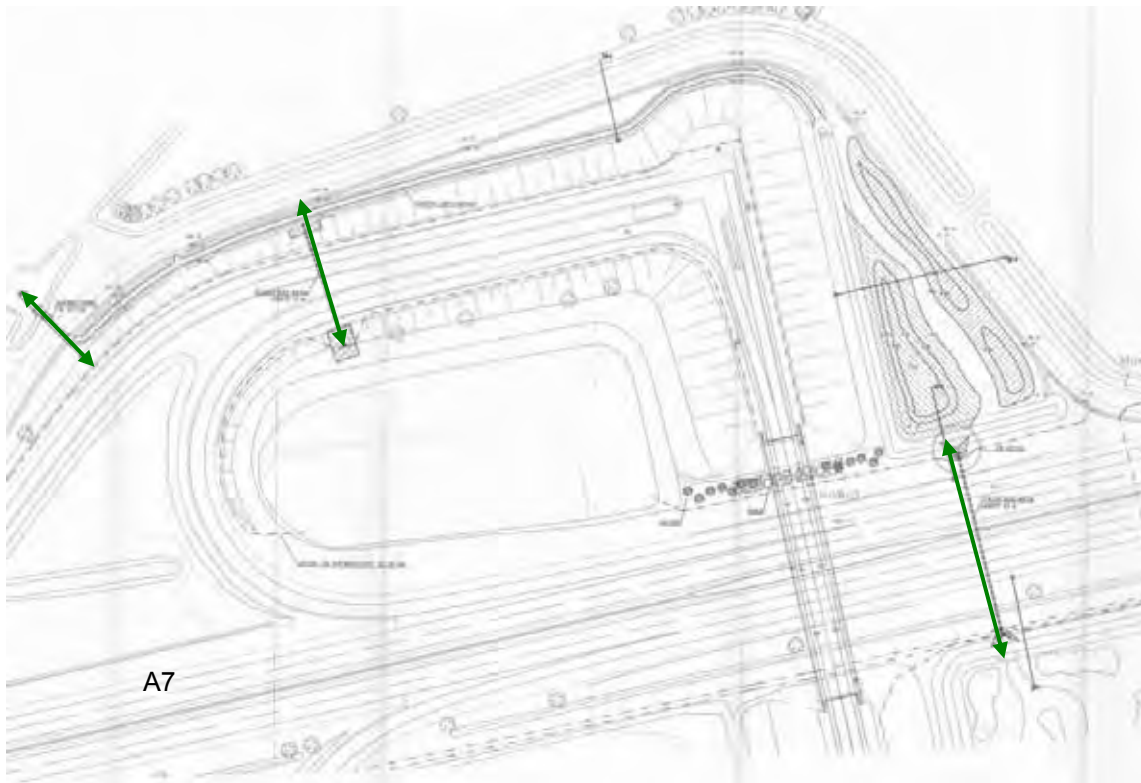
Figuur 9: Inrichting ecologische verbindingszone met faunapassages (groene peilen) binnen klaverblad Hoorn.
