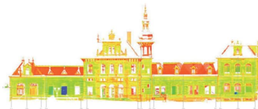
Figuur 3: Voorbeeld Puntenwolk van 3D-scan bestaande stationsgebouw
