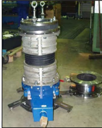
Fig. 6 en 7: Voorbeelden van een eenvoudige sluis voor het uitvoeren van kernboringen resp. een complexere flexibele sluis voor het maken van gewi-palen.
