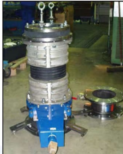
Fig. 6 en 7: Voorbeelden van een eenvoudige sluis voor het uitvoeren van kernboringen resp. een complexere flexibele sluis voor het maken van gewi-palen.
