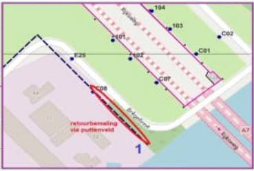
Locatie puttenveld voor retourbemaling onder Drenthe klei 16 putten met capaciteit 10 - 15 m 3 /uur
