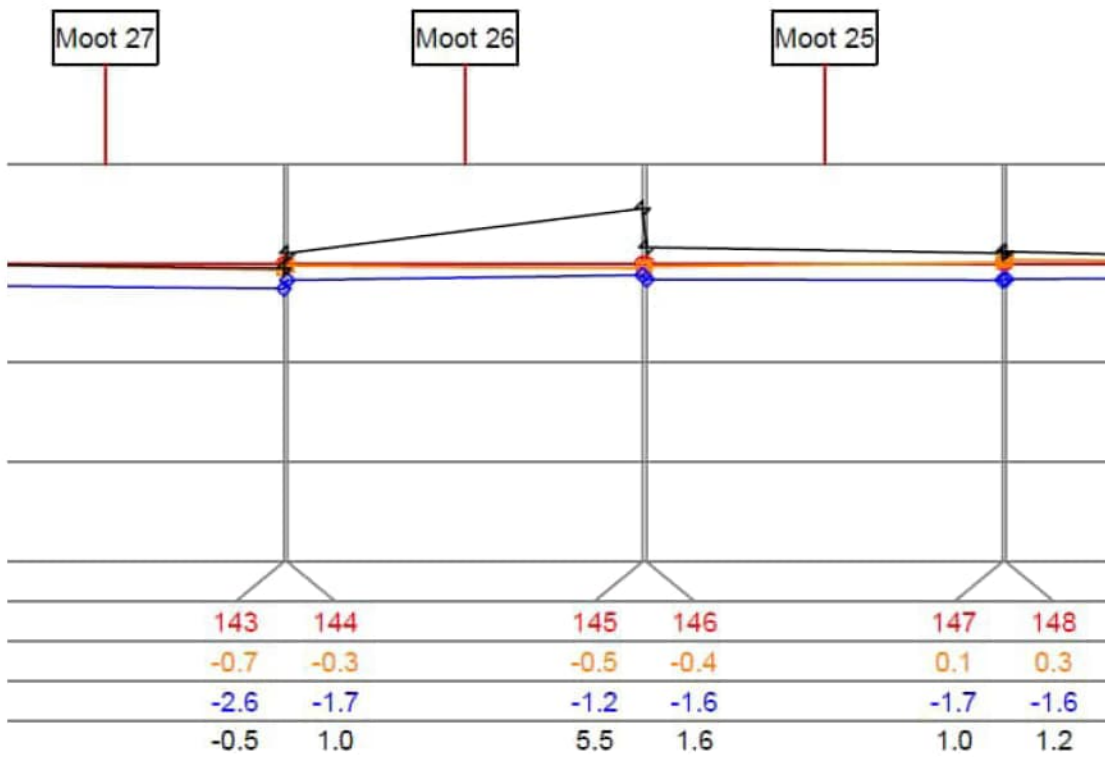
Figuur 3.3 Verticale deformatie oostzijde van de tunnel [in mm] (1 e regel nummer meetpunt. (rood); achtereenvolgens de deformatie metingen in januari 2013 (oranje), november 2017 (blauw), juni 2021 (zwart)) [12].
