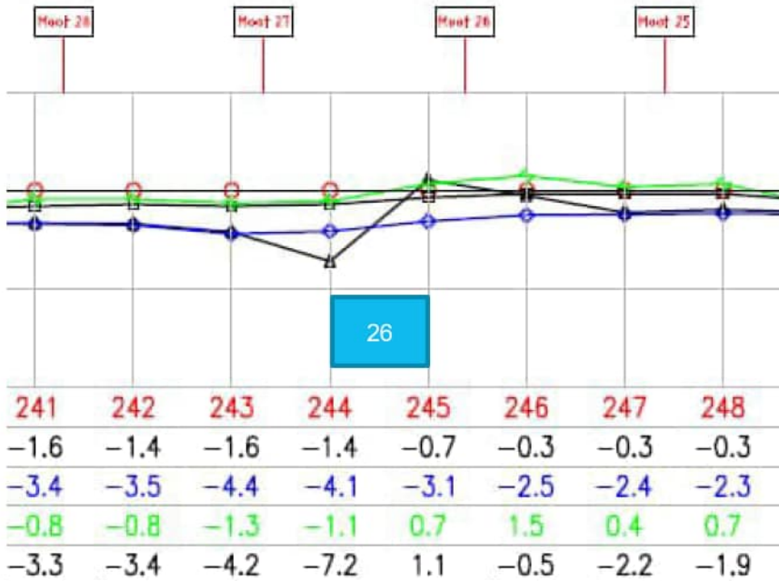
Figuur 3.5 Deformatie metingen westzijde van de tunnel t.p.v. schade (noot: de teksten moot 26 t/m 28 staat vermoedelijk op de verkeerde positie, de verwachte positie moot 26 is met een blokje weergegeven) (1 e regel nummer meetpunt. (rood); achtereenvolgens de deformatie metingen in januari 2013 (zwart), november 2017 (blauw), juni 2021 (groen) en december 2022 (zwart) [12] tekening 10H-302-(01+02)-04-ZG-03 100Z.pdf.
