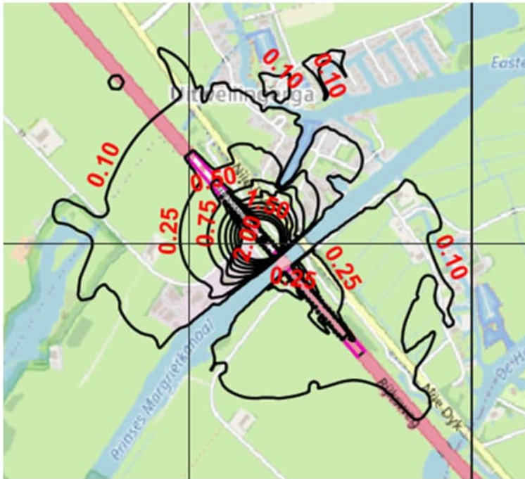
Figuur 2-11: Daling grondwaterstand als gevolg van bemaling moot 26 tot NAP -10,3 m
