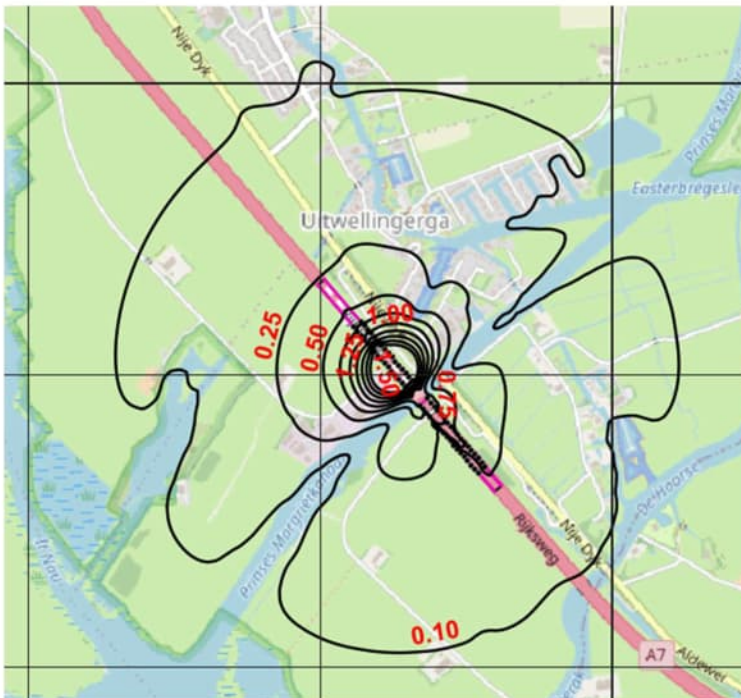
Figuur 2-12: Daling waterspanning in tussenzandlaag (boven Keileem) als gevolg van bemaling moot 26 tot NAP -10,3 m
