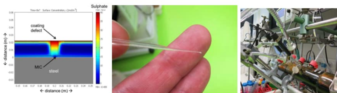
Figuur B3.4 Voorbeelden van methoden om MIC te onderzoeken: veldproeven in peilbuizen; DNA detectiemethoden, modellen, microsensoren.
