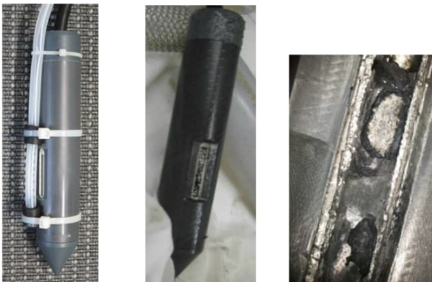
Figuur B3.3 ER probe voor het bestuderen van microbiele corrosie. Links: ER probe voor blootstelling; midden: ER probe met biofilm en corrosieproducten; rechts: oppervlak ER probe na aantasting door MIC (na verwijdering biofilm en corrosieproducten) (close-up).
