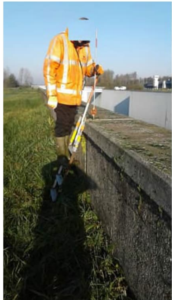
Opname van een deformatiemeetpunt met een trapje
