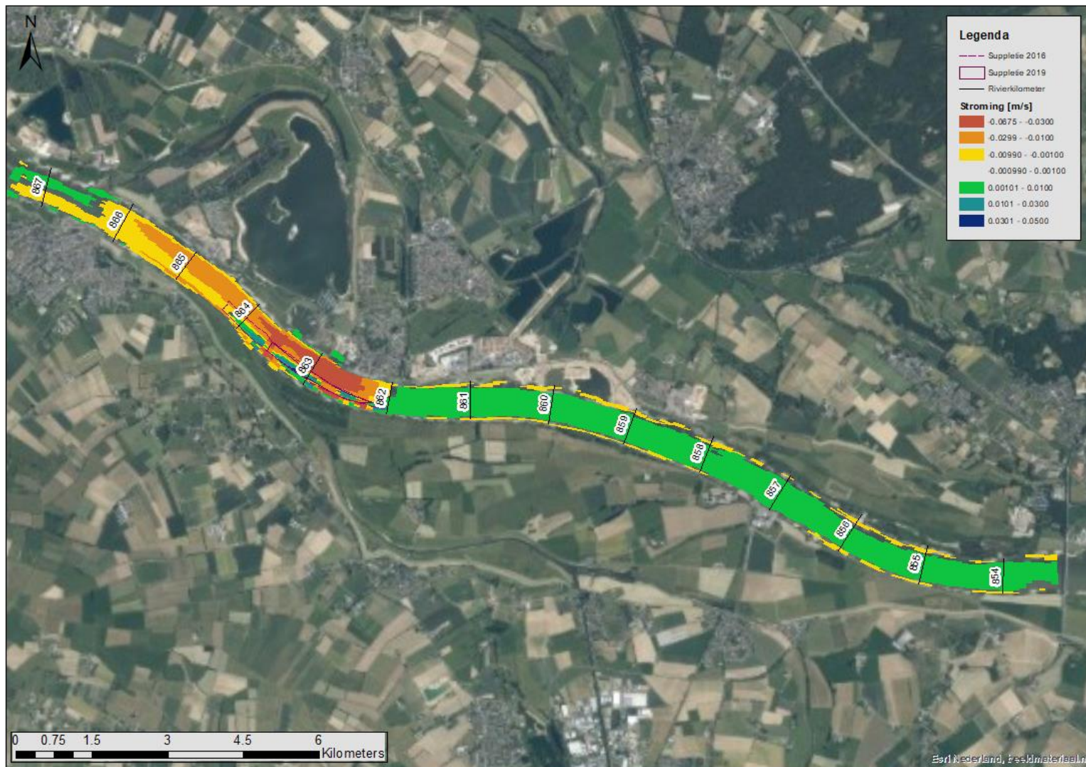
Figuur 22 Verschil in stroomsnelheid (referentie – situatie met suppletie) tussen situatie met en zonder suppleties voor een afvoer van 2.250 m 3 /s uit de prognoseberekening
