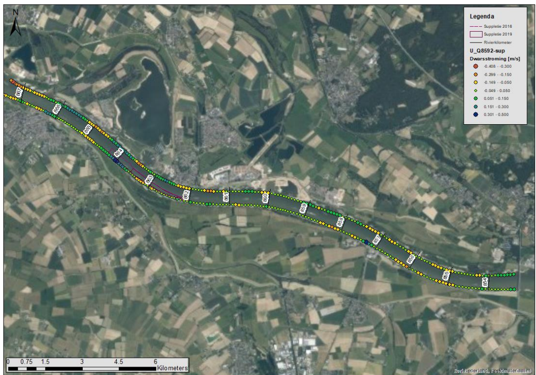
Figuur 16 Dwarsstroming bij een gemiddelde Rijnafvoer ( 2.250 \text{ m}^3/\text{s} ) voor de situatie zonder suppleties (boven) en met suppleties (onder). Gegevens uit de prognose berekening na een simulatieperiode van 3 jaar (direct na de 2 e suppletie).
