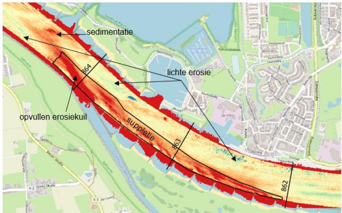
Figuur 15 Bodemhoogteverschil tussen 2017 (week 39) en 2016 (week 14), dus tussen vóór het hoogwater 2018 en voor aanleg van de eerste suppletie. De rode vlakken in de kribvakken zijn geen echte bodemveranderingen, deze ontstaan door de manier van verwerking van de bodempellingen naar een verschil, op plekken waar niet beide invoerpeilingen data bevatten.
