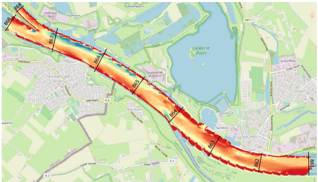
Figuur 28 Bodemligging in 2019, week 12, net voor aanleg van de tweede suppletie.
