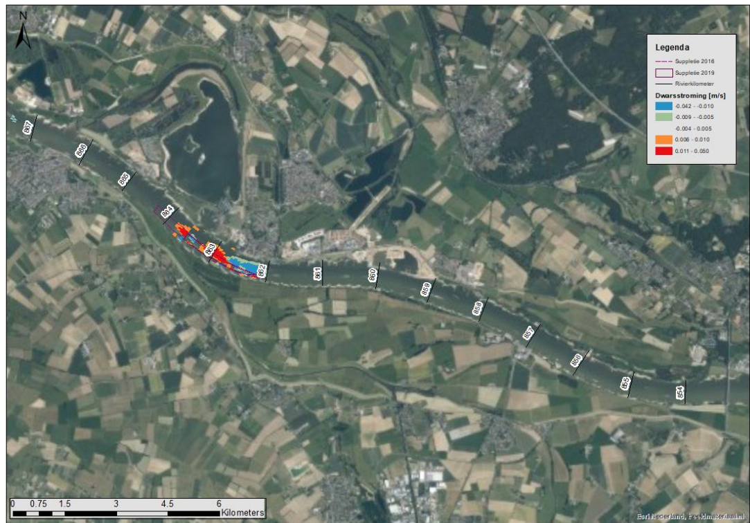
Figuur 24 Verschil in dwarsstroming (referentie – situatie met suppletie) voor een afvoer van 2.250 \text{ m}^3/\text{s} .
