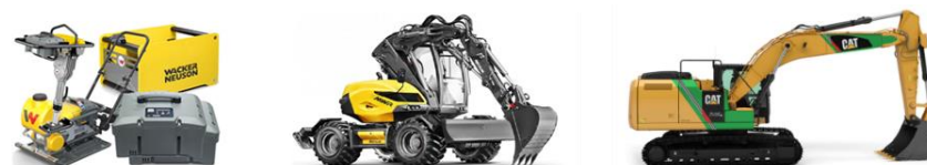
Figuur 1 - Voorbeelden van elektrisch bouwmaterieel, v.l.n.r., trilplaat, wiel- en rupsgraafmachine
