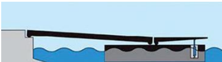
Afbeelding 2.19 Floating linkspan ponton [ref. 4]
