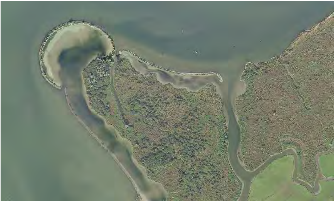
Figuur 4.16 Luchtfoto Korendijksche slikken. Na het wegvallen van het getij in het Haringvliet door de aanleg van de Haringvlietsluizen in 1970 vond er veel erosie plaats door golfslag, met name in de gebieden waar vol de wind op staat, zoals de Beninger en Korendijksche slikken. Een maatregel om de erosie tegen te gaan was het plaatsen van vooroeververdedigingen (foto: Aerodata International Surveys, 2005).
