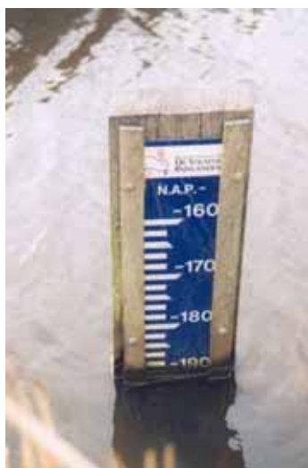
Figuur 3.5 en 3.6 Peilschaal hoogheemraadschap de Stichtse Rijnlanden (foto: Ing. BCC) en peilmeetstation Lobith (foto: beeldbank RWS).
