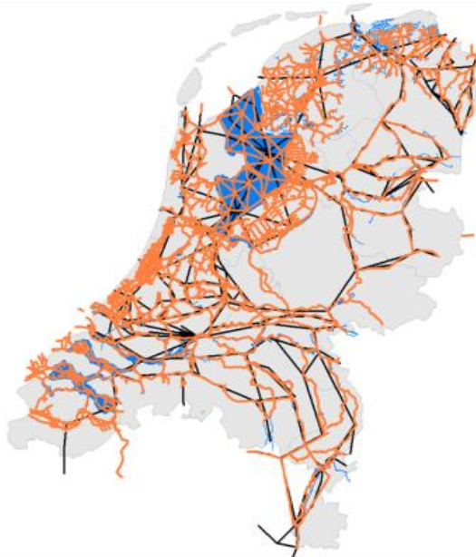
Figuur 4-1 Het netwerk van het Landelijk Sobek Model voor Sobek 2 (oranje) en in de achtergrond de eenheden van het veel grovere Distributie Model (zwart),
