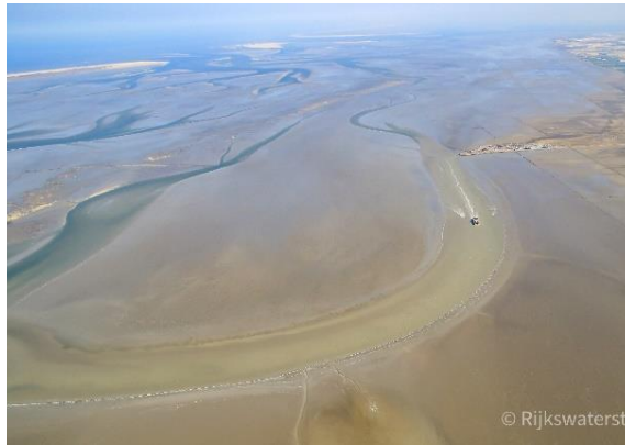
Hoge vertroebeling in de Vaargeul bij Holwerd en helderder water in naastgelegen geulen. Rechtsboven de veerdam en de landaanwinningwerken.
