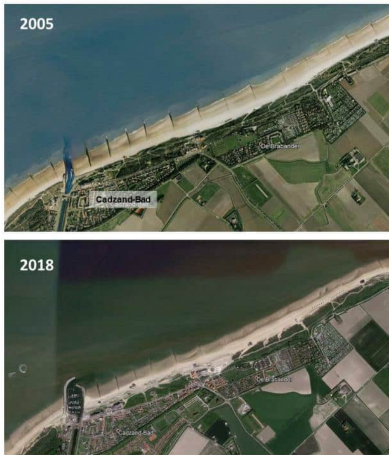
Figuur 2-2 - Kustversterking Zwakke Schakel Cadzand-Bad voor (2005) en na (2018). Bewerkt uit Google Earth afbeeldingen
