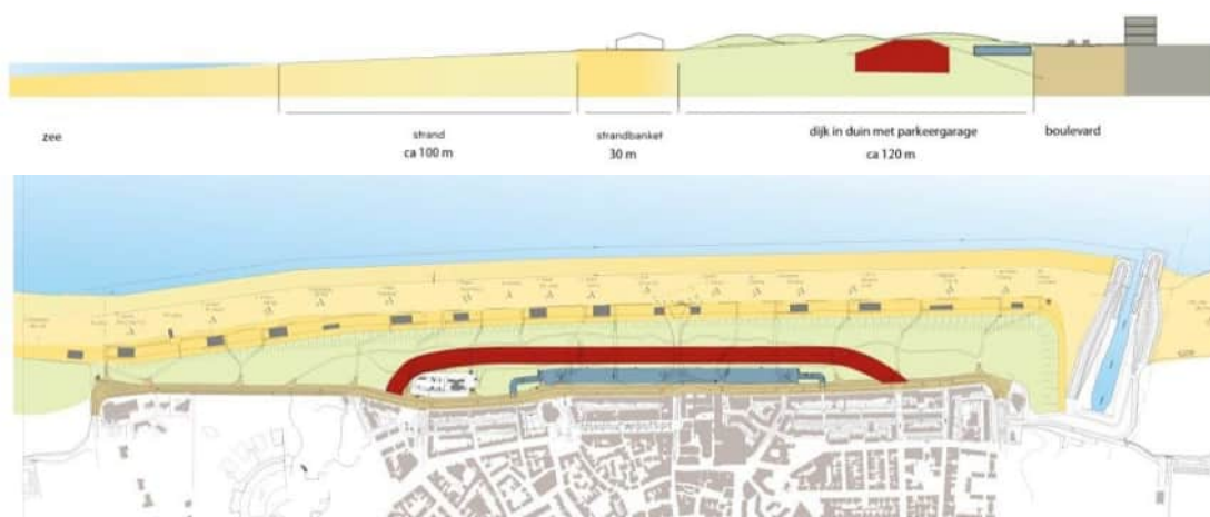
Figuur 2-12 Ontwerp dijk-in-duin bij Katwijk dwarsdoorsnede (boven) en bovenaanzicht (onder) (bron: Arcadis, 2013)
