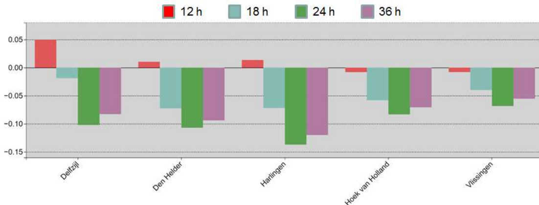
Figuur 28: BIAS waarden van het DCSMv6-Zunov4-model voor alle hoofdstations voor de week van 16 - 23 februari 2022
