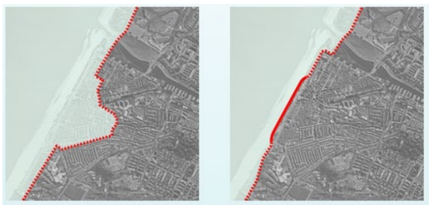
Figuur 2-2 Primaire waterkering Katwijk voor (links) en na (rechts) de Zwakke Schakel versterking (bron: Arcadis, 2013)
