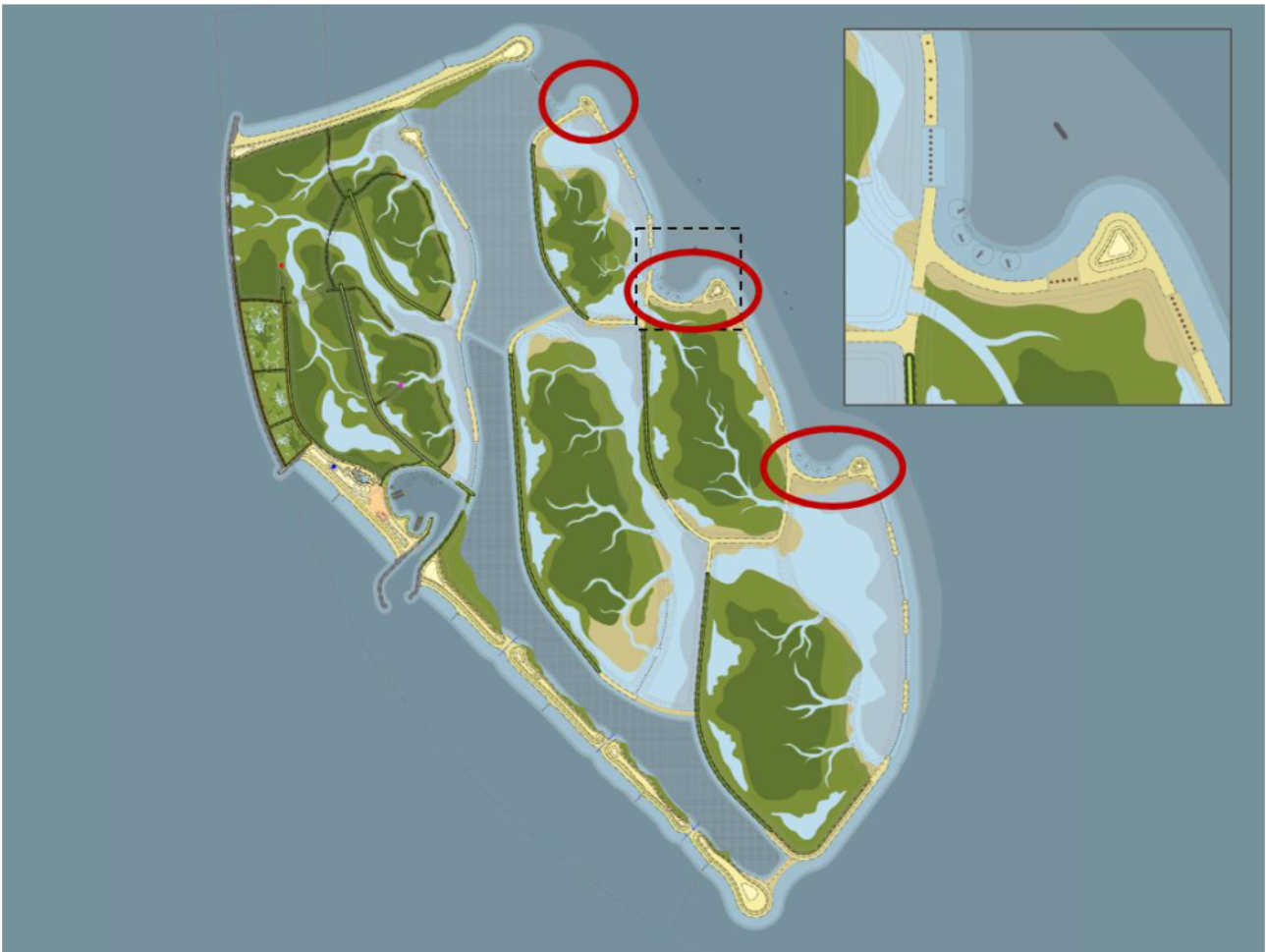
Figuur 22 Overzichtstekening van het ontwerp van de Marker Wadden; inclusief een detailweergave van het ontwerp van de overgangszones tussen de geschakelde moeras-eilanden van module D, inclusief zandige koppen.
