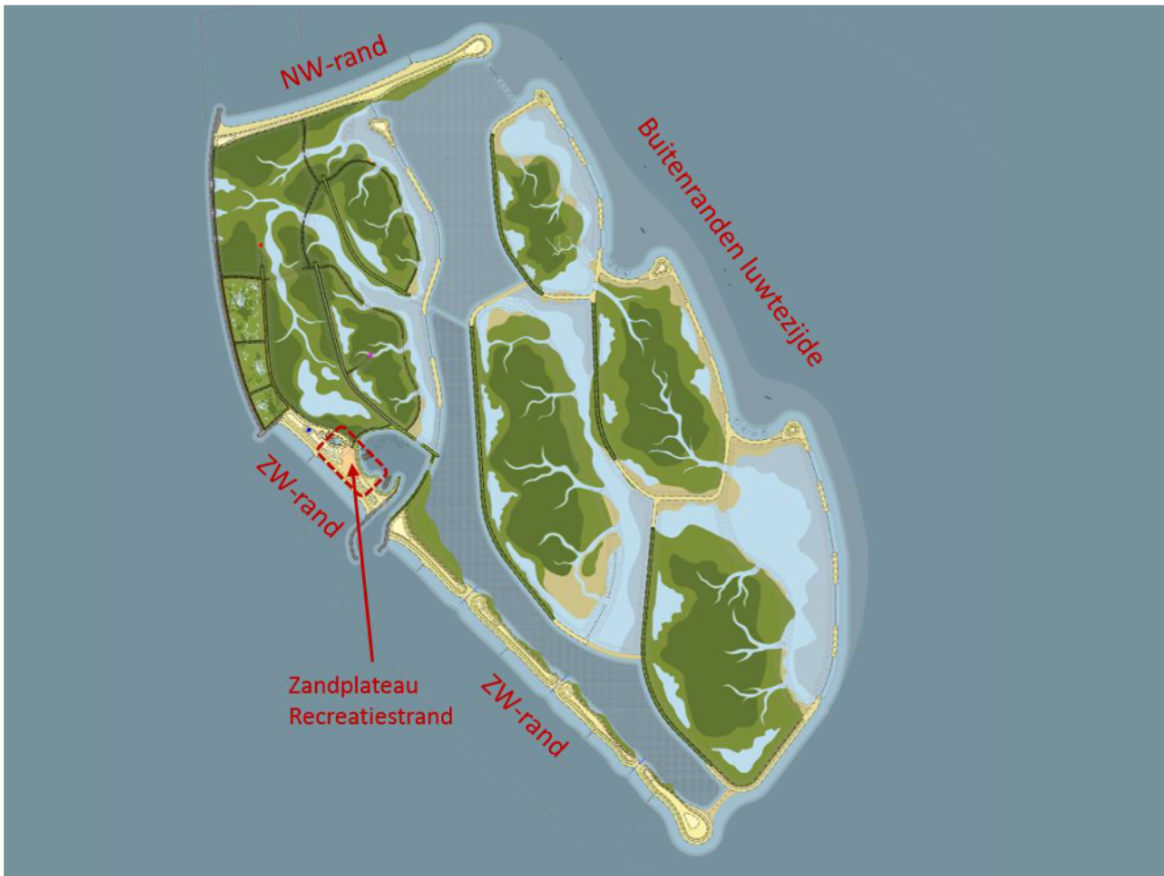
Figuur 3 Overzichtstekening van het ontwerp van de Marker Wadden; inclusief aanduiding van de relevante zandige onderdelen van modules A, B en C van de Marker Wadden (objecten RA2, IE1 en IE3).
