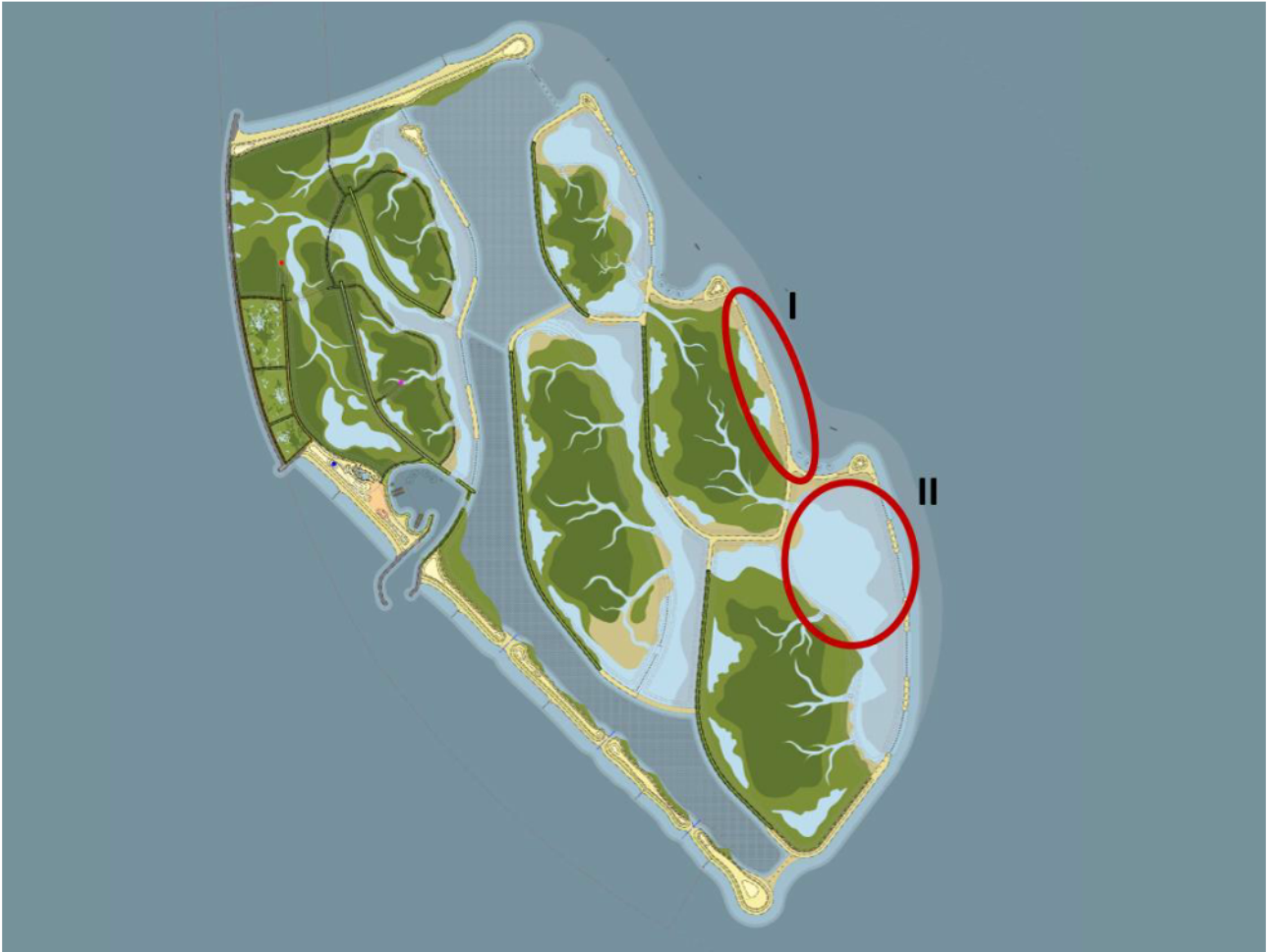
Figuur 25 Overzichtstekening van het ontwerp van de Marker Wadden; met aanduiding van twee aandachtsgebieden in het ontwerp van module D: (I) zandrand tussen 'plas-dras' en 'diep water' zonder tussenliggend 'beschut ondiep', (II) relatief groot gebied met 'beschut ondiep'.
