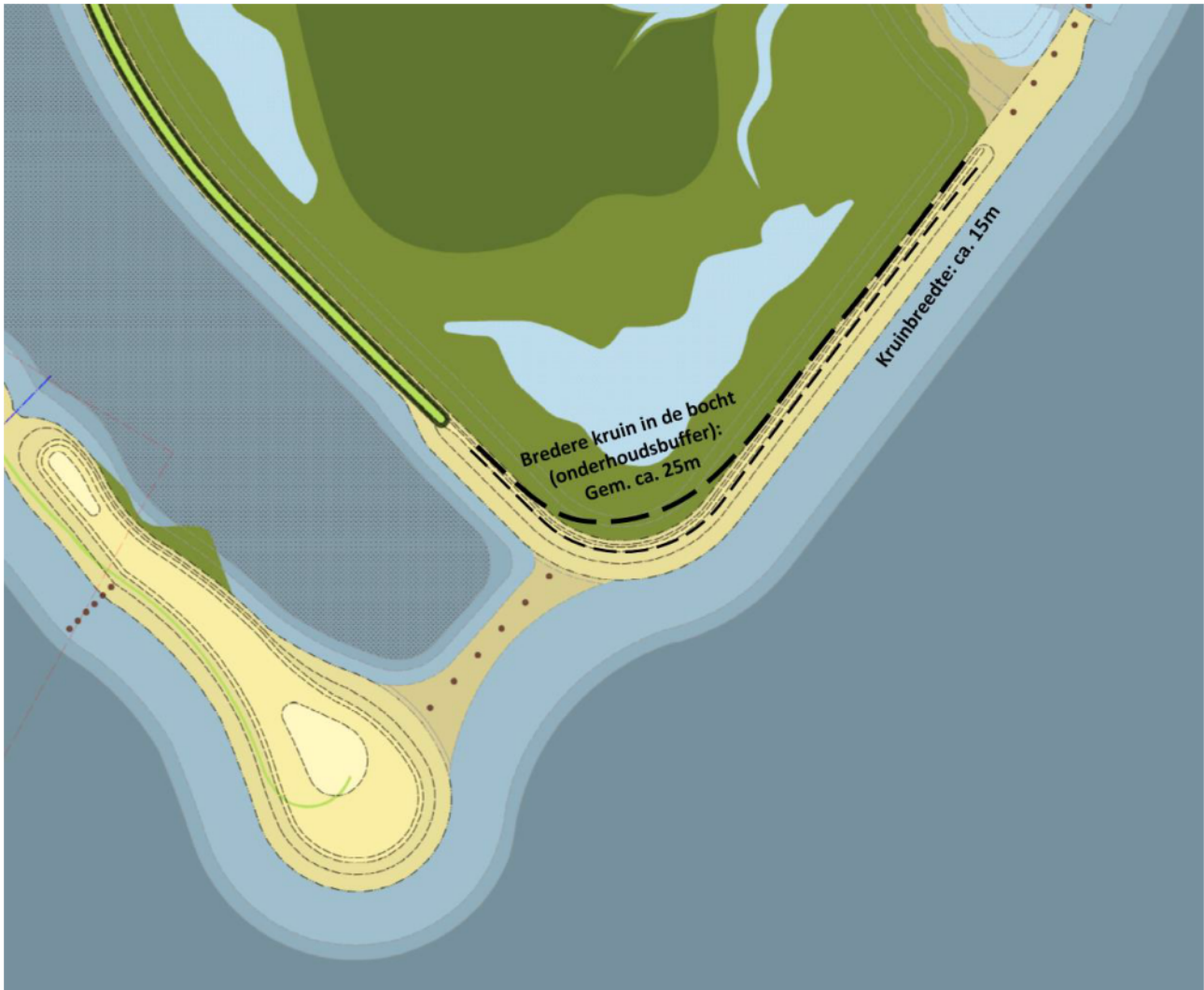
Figuur 24 Detailweergave van zuidpunt van moeraseiland D3, met voorgestelde ontwerpwijziging (t.o.v. DO-tekening) om met robuustere vormgeving de zachte zuidostrand beter bestand te maken tegen (structurele) erosie en functieverlies.
