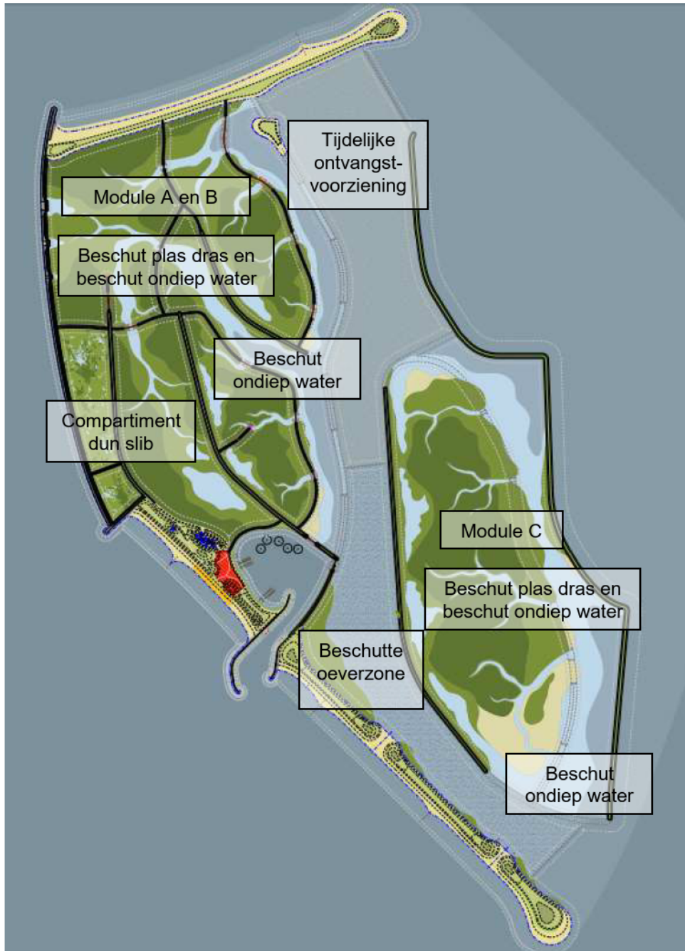
Figuur 1: Overzicht Ontwerp eerste fase Marker Wadden met ontwerp onderdelen landaanwinning, gebaseerd op overzichtstekening DO Ruimtelijke Kwaliteit.
